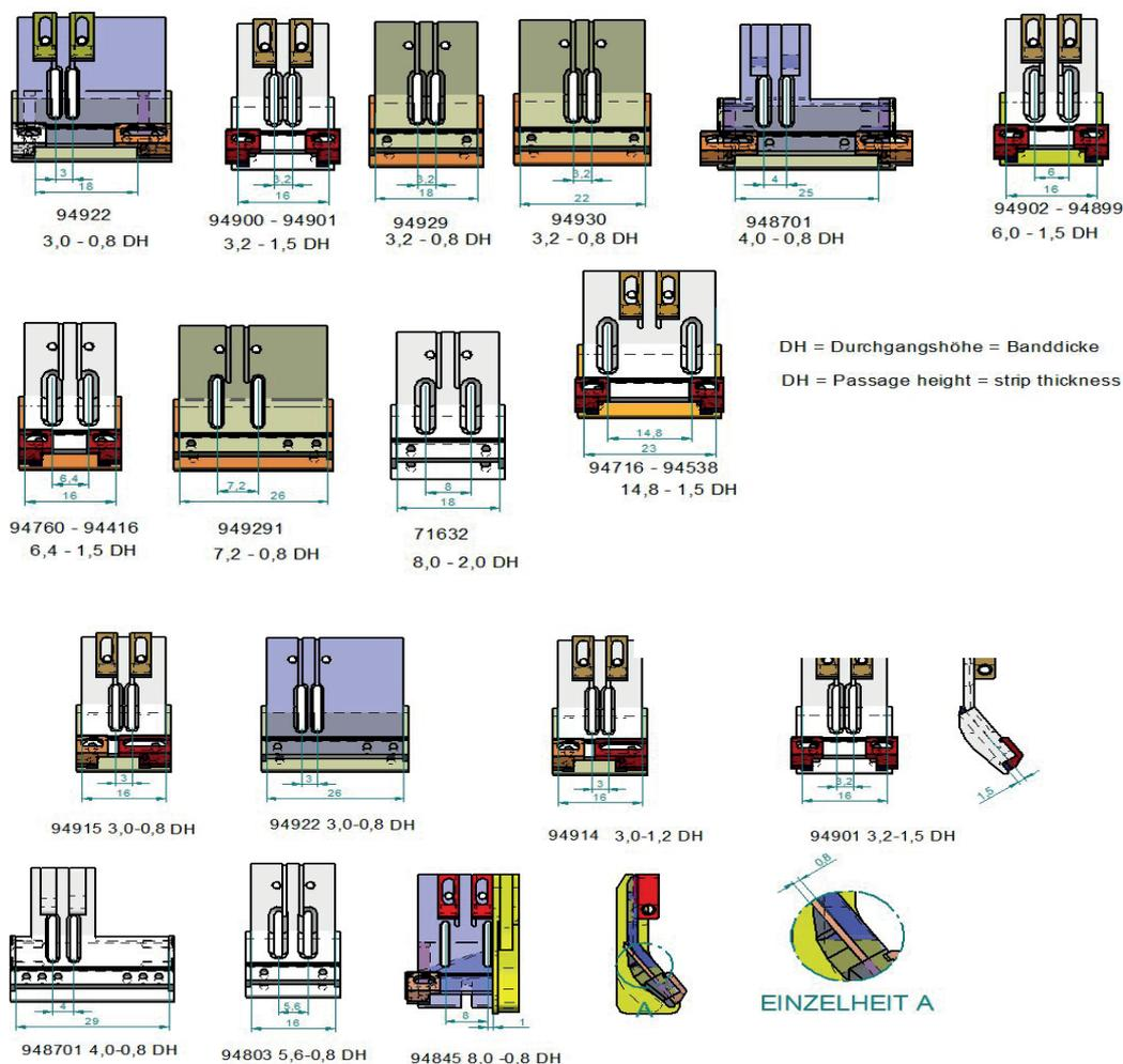
Nähfüße für Kettenstichmaschinen ein- und zweiteilig
