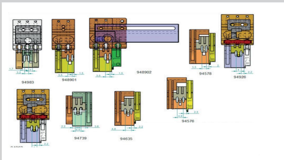
Dreiteiliger Mini-Nähfuß mit Klettersohlen zum Säumen für Überdeckstich-Nähmaschinen mit Überstichbreiten von 3,2- 4,8 mm
