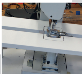
Maschine mit Y-OKE Führung
