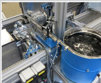
Ultraschall Schweißmaschine mit
