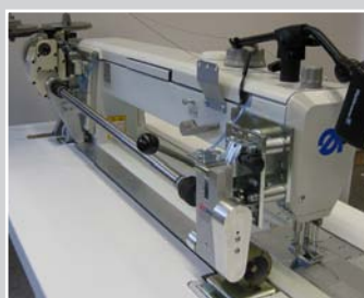
Puller einteilig, mit angetriebenen Transportwalzen oben und unten Walzendurchmesser 54 mm
