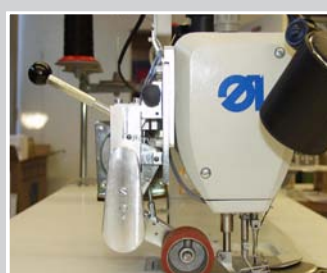
Puller einteilig, 54 mm Zusatztransport für das Nähgut
