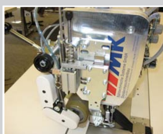
Puller zweiteilig, 54 mm mit Schrittmotor
