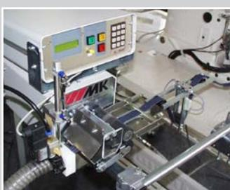
Bandschneidegerät 100 mm mit pneu-
