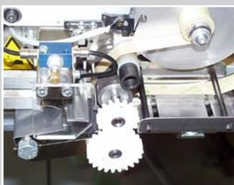
Spezielschneidegerät mit Deckfolien-Abzugsvorrichtung
