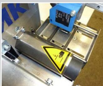
Spezielschneidegerät mit Markierungsleseeinrichtung
