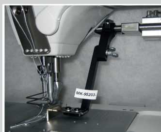
Pneumatisch hochschwenkbarer Mehrstellungsanschlag. Bis zu vier Kantenabstände können abgerufen werden.
