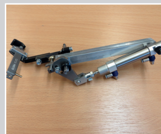
Pneumatisch hochschwenkbarer Stoffkantenanschlag rechts der Nadel mit Zylinder für zwei Kantenabstände.
