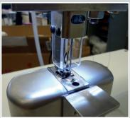
Schaltbalg-Näheinrichtung für Koffernaht
