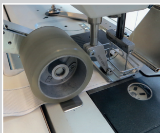
Puller einteilig, Walzendurchmesser 54 mm
