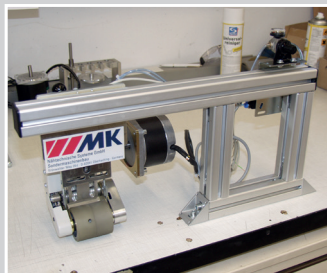
Puller zweiteilig, 54 mm mit Schrittmotor stationär hinter der Maschine
