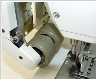
Puller zweiteilig, Walzendurchmesser 54 mm
