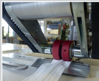
Puller zweiteilig, Walzendurchmesser 28 mm
