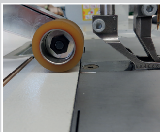
Puller einteilig, Walzendurchmesser 28 mm
