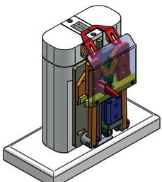
Nahtmitteführung . Koffernahtführung unten an Säule montiert
