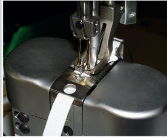
Nahtmitteführung mit Band an einer Säulenmaschine
