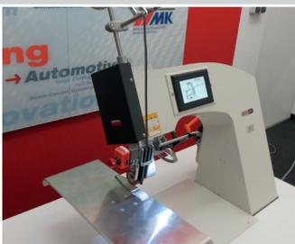
Klebeband-Auftragsmaschine mit Auflagetisch.
