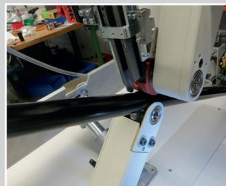
Klebeband-Auftragsmaschine zum Aufbringen eines Klebebandes auf ein Kunststoffrohr.
