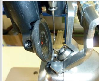
Kappnahtführung 2teilig rechts mit schräger Rolle
