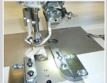
Kappnahtführung 2-teilig links mit schräger Rolle mit Nahtumleger fingers links und rechts an einer Flachbettmaschine
