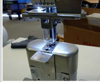
Schaltbalg an einer Säulenmaschine
