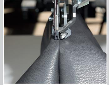
Kappnahtführung 2t-eilig rechts mit schräger Rolle
