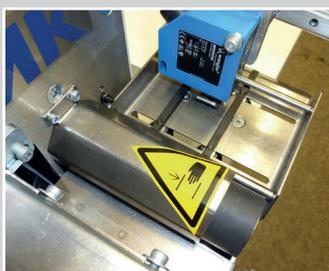
Speziellschneidegerät mit Markierungsleseeinrichtung
