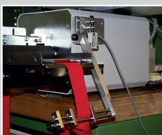
Schneidgerät mit Bandknoten-Stoppereinrichtung
