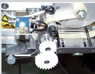
Speziellschneidegerät mit Deckfolien-Abzugsvorrichtung
