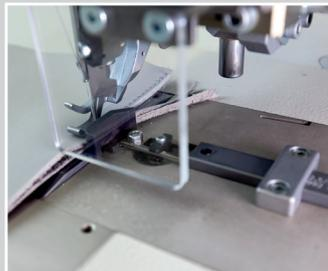
Gegenmesser normale Version, an einer Flachbett/Radtransport/Nähmaschine mit pneumatischem Kantenanschlag
