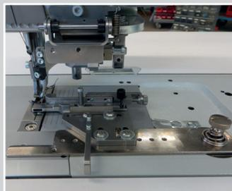
Gegenmesser an einer Flachbett/Hüpferttransport/Nähmaschine, Greifer rechts, mit integrierter Paspelführung
