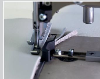
Gegenmesser normale Version, an einer Flachbett/Radtransport/Nähmaschine mit pneumatischem Kantenanschlag
