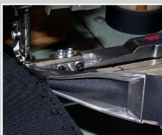
Halbschräger Einfasser an einer Ein-Nadel-Nähmaschine
