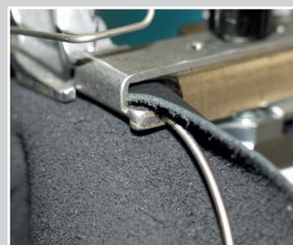
Spezialeinfasser für eine Schalthebelverkleidung mit Metallring-Einlauf
