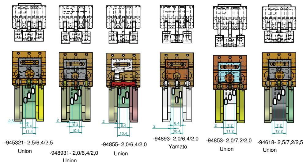
Zwei-Nadel- und Drei-Nadel-Kettenstichfüße für Kappnähte dreiteilig. Es kann mit einem Rechtskapper oder mit einem Linkskapper genäht werden. Die rechte oder linke Kappnaht kann damit immer von oben nach unten genäht werden.
