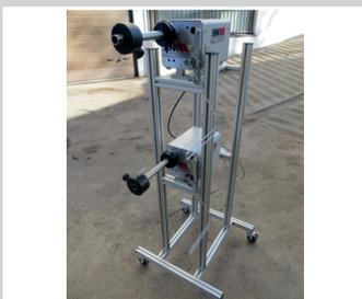
2x Bandspender groß Rollenkernantrieb mit Tänzersteuerung auf Rollengestell
