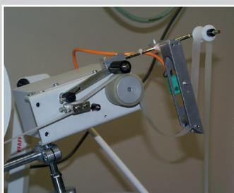
Bandspender klein mit Transportwalze 35 mm und Sensorsteuerung
