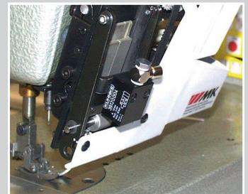
Kleine Bandschere an einer Zick-Zack-Maschine
