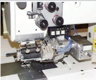
Starke Schere mit pneumatischem Einschub
