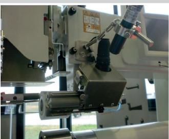
Starke Bandschere an einer Heißluft-Schweißmaschine, Schnittbreite 55 mm
