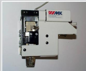
Kleine Bandschere an einer Strobel-Blindstichmaschine
