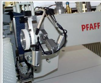
Bandmesseinrichtung für automatischen Schnitt. Schere vor der Nadel
