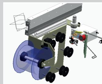
Bandrollenhalter seitlich ausfahrbar, mit integrierter Bandüberwachung und Bandspender für Montage unter der Tischplatte
