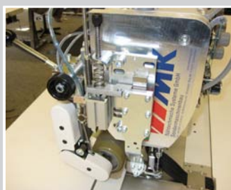
Puller zweiteilig, 54 mm mit Schrittmotor
