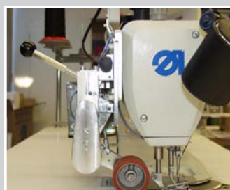
Puller einteilig, 54 mm Zusatztransport für das Nähgut
