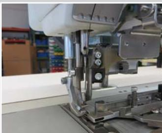
Gegenmessermesser an einer Flachbett/ Hüpferttransport/Nähmaschine, Greifer rechts, mit integrierter Paspelführung
