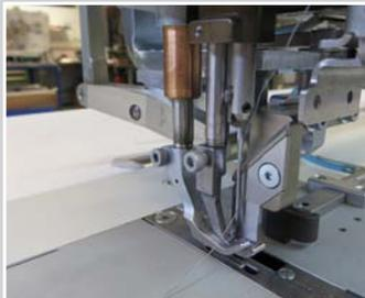
Gegenmessermesser an einer Flachbett/Hüpferttransport/Nähmaschine, Greifer links, Messerhub vom 2,0 bis 8,0 mm
