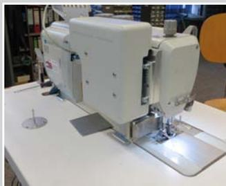
Gegenmessermesser an einer Flachbett/Hüpferttransport/Nähmaschine, Greifer rechts, Kurzfadensabschneider
