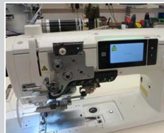
Gegenmessermesser an einer Flachbett/Hüpferttransport/Nähmaschine, Greifer rechts, Kurzfadensabschneider
