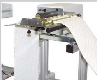
Bandspender groß mit Transportwalze 200 mm mit Sensorsteuerung
