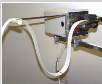
Bandspender groß mit Transportwalze 100 mm mit Tänzersteuerung
