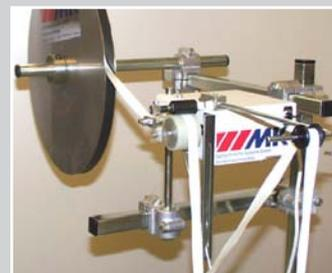
Bandspender klein mit Transportwalze 35 mm und Tänzersteuerung
