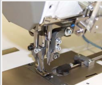
Stanzmesser an einer Flachbett/ Hüpferttransport/Nähmaschine mit pneumatischen Kantenan- schlag
