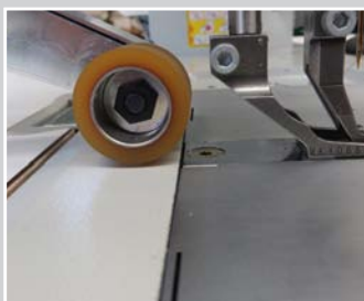
Puller einteilig, Walzendurchmesser 28 mm
