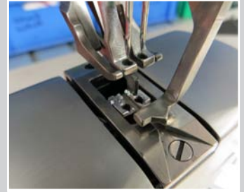
Nahtmitteführung und Pflugführung für eine Stummelnaht ohne Band
