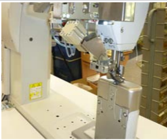
Nahtmitteführung und Pflugführung mit Verstellung vor /zurück an einer Säulenmaschine
