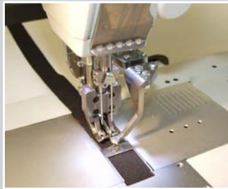
Nahtmitteführung und Pflugführung für eine Koffernaht mit Band von unten
