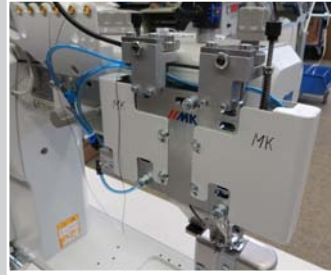
Nahtmitteführung und Pflugführung mit reproduzierbarer Höhenfeineinstellung an einer Säulenmaschine
