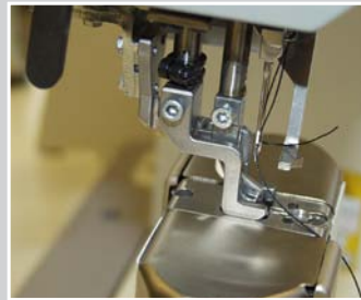
Nahtmitteführung und Pflugführung hinten extra hoch an einer Säulenmaschine
