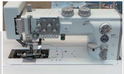
Zweinadelmaschine mit Messerantrieb
