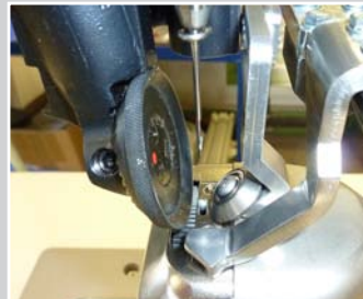
Kappnahtführung 2teilig rechts mit schräger Rolle
