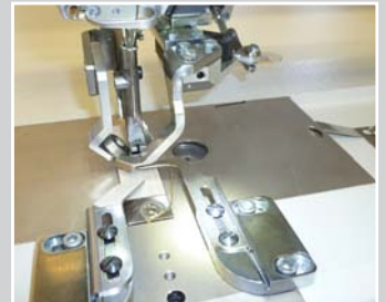
Kappnahtführung 2teilig links mit schräger Rolle mit Nahtumlegefinger links und rechts an einer Flachbettmaschine
