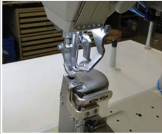
Kappnahtführung 2teilig rechts mit schräger Rolle mit pneumatischer Führung von unten
