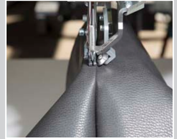
Kappnahtführung 2teilig rechts mit schräger Rolle
