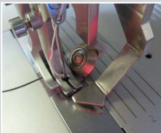
Kappnahtführung 2teilig rechts mit schräger Rolle an einer Flachbettmaschine
