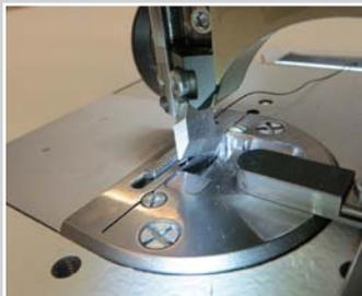
Gegenmessermesser normale Version, an einer Flachbett/Radtransport/Nähmaschine mit pneumatischen Kantenanschlag
