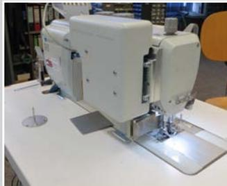
Gegenmessermesser an einer Flachbett/Hüpferttransport/Nähmaschine, Greifer rechts, Kurzfadensabschneider
