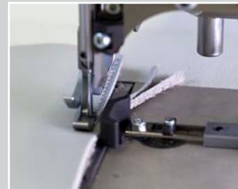
Gegenmessermesser normale Version, an einer Flachbett/Radtransport/Nähmaschine mit pneumatischen Kantenanschlag
