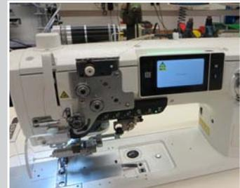
Gegenmessermesser an einer Flachbett/Hüpferttransport/Nähmaschine, Greifer rechts, Kurzfadensabschneider
