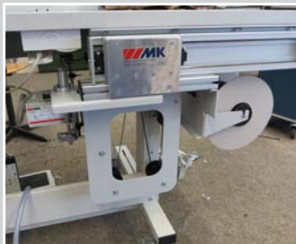
Bandrollenhalter seitlich ausfahrbar mit integrierter Bandüberwachung und Bandsponder für Montage unter der Tischplatte
