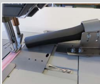
Absauger oberhalb der Tischkante
